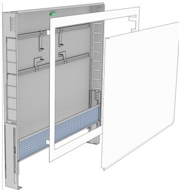
Verzinkter Universal-Stahlblechschrank (1mm), Anschlussmöglichkeit von unten oder seitlich, höhenverstellbaren Füßen mit Sonderlänge bis 32cm Bodenaufbau, Putzblende unterhalb vom Schrank, inkl. an der Putzblende vorstehenden Verputznetz und Verputzschutz für die Schrankinnenseite, inkl. Verteilerhalterungen, verzinkte, absperrbare Fronttüre und Rahmen, pulverbeschichtet.
