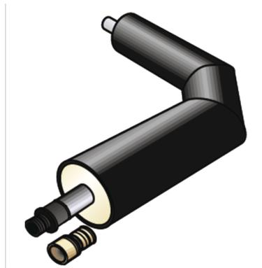
Vorisolierter, geschweißter Stahl-Bogen ST 37.0, INKLUSIVE einseitig aufgeschweißter Mediumrohrverbindung (PEX13), OHNE Mantelrohrverbindung, die in Klammer angeführten Werte stellen die tatsächlichen, konstruktiv bedingten Mantelrohr-Aussendurchmesser dar!
