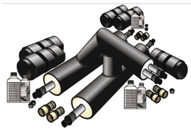
Vorisierte, geschweißte Stahl T-Stücke, egal oder reduziert, im Durchgang PEX-Einzelrohre, im Abgang PEX-DUO Rohre, 90° etagiert (bei Bestellung die Abgangsrichtung angeben), INKLUSIVE 6 aufgeschweißten Mediumrohrverbindungen (PEX13) und 5 Mantelrohrverbindungs-muffen (PEX40 oder PEX45)
