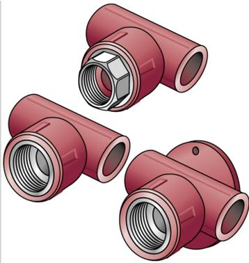
KETRIX Polyfusions-Schweißformstück, Verbindung von POB Rohren und werkstoffgleichen Fittings ohne Querschnittsverengung, mit eingespritztem Innengewinde aus entzinkungsbeständigem Messing und porenfreier Metallisierung, Gewinde gemäß ÖNORM EN 10226
