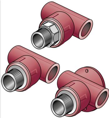
KETRIX Polyfusions-Schweißformstück, Verbindung von POB Rohren und werkstoffgleichen Fittings ohne Querschnittsverengung, mit eingespritztem Außengewinde aus entzinkungsbeständigem Messing und porenfreier Metallisierung, Gewinde gemäß ÖNORM EN 10226
