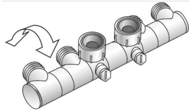
Für Ventilheizkörper, mit 4 stufenlos drehbaren Rohr-Anschlüssen als Durchgangs- oder Eckanschluss zum Durchschleifen des Vor- und Rücklaufes ohne Verbindungsstellen im Bodenbereich sowie zentrischen, absperrbaren HK-Anschlüssen 3/4" IG Überwurfmutter, Rohrseitig 3/4" AG Eurokonus, Messing porenfrei vernickelt, Kompatibel mit KM220 d16 und d20
