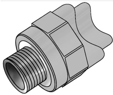
KELEN Polyfusions-Schweißformstück, Verbindung von Rohren und werkstoffgleichen Fittings ohne Querschnittsverengung, mit eingespritzten Außengewinde aus entzinkungsbeständigem Messing und porenfreie Metallisierung, Gewinde gemäß ÖNORM EN 10226. Zum direkten Einschweißen in bestehende Rohrleitungen, die Schweißung erfolgt mit dem WZ124 Sattel-Schweißwerkzeug
