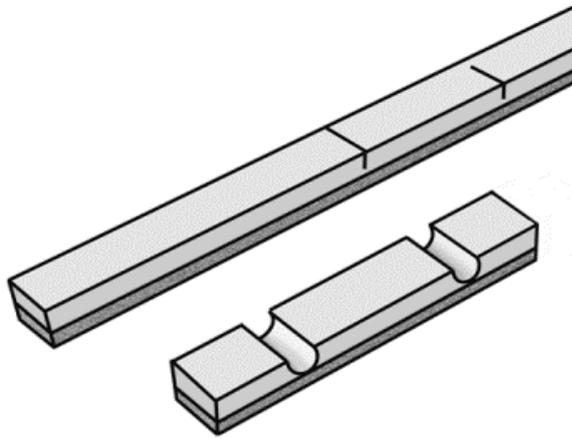
Rahmenholz umlaufend lose verlegt, zur Verbesserung der Druckfestigkeit. Bei Türdurchgängen wird das Rahmenholz festgeschraubt, um bei Belagwechsel die Oberprofilschienen festschrauben und die nötige Stabilität bieten zu können.
